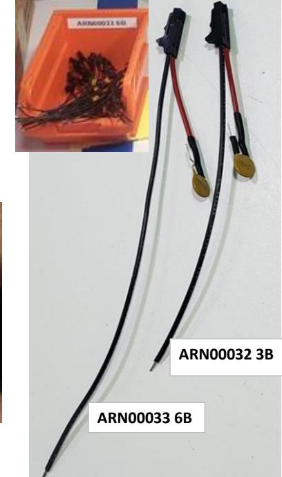
NOTA: SI DETECTAMOS UN CABLE MAL CRIMPADO, TERMINAL DAÑADA O QUE NO SE PUEDE INSERTAR AL CONECTOR, MANDAR A SCRAP Y ANOTAR EN EL FORMATO IMTECH-FPROD-001 (ELABORACIÓN DE ARNÉS).
