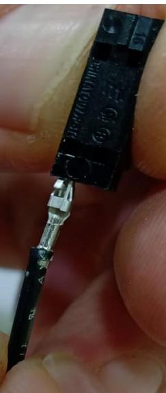
8° Insertar terminal del cable rojo en el orificio derecho.
