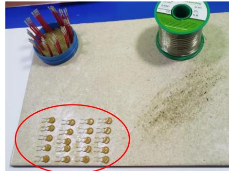
3° Soldar terminal (patita) del termistor al cable rojo. Puede soldarse en cualquier terminal de nuestra preferencia, ya que el termistor no tiene polaridad.
